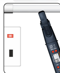
● NCCD, 精準數字式探測AC電流強弱跳動
