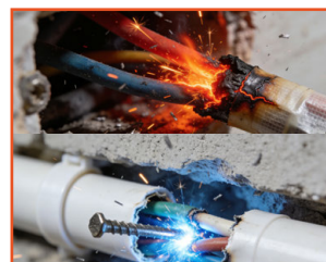
● 施工欠佳; 裝修疏忽; 寵物破壞導致漏電或者火災
