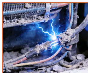
● 電器污積散熱通風空間不夠, 或者故障長時間高用電量導致發熱引起火災隱患
