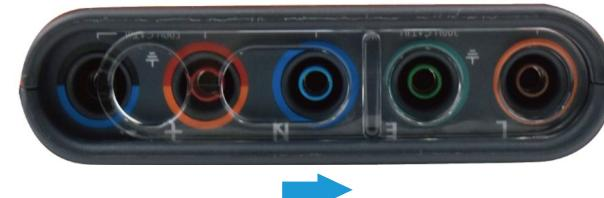
圖二. 向右方滑動滑動透明聯鎖蓋，用於漏電保護測試與環路測試功能。
