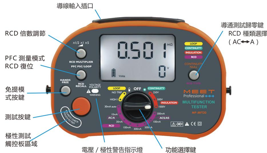
MP-MFT20 採用大型 LCD 顯示屏，主顯示區域顯示進行中測試的結果。同時，下方輔助顯示區域顯示該項測試的其他信息。
